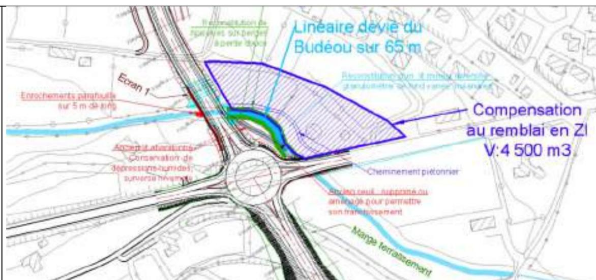
**FIGURE 36 : DÉVIATION ET RENATURATION DU BUDÉOU ENTRE LA RD572 ET LE PROJET (OA N°3) (SOURCE : INGEROP, 09/2012)**
